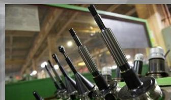
当社機械加工部門は、JSW 日本製鋼所グループとして、紡糸押出機、中空成形機などの樹脂機械製品の主力部品であるスクリュ、樹脂流路部品の機械加工を手掛けてきました。
